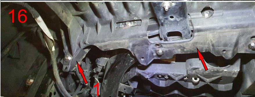
Innenkotflügel einsetzen und die restlichen Schrauben ansetzen
