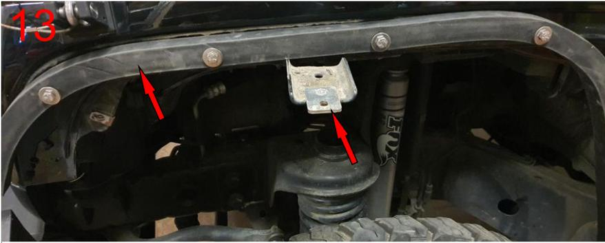
Spacer mit den oberen 4 Schrauben vormontieren.
