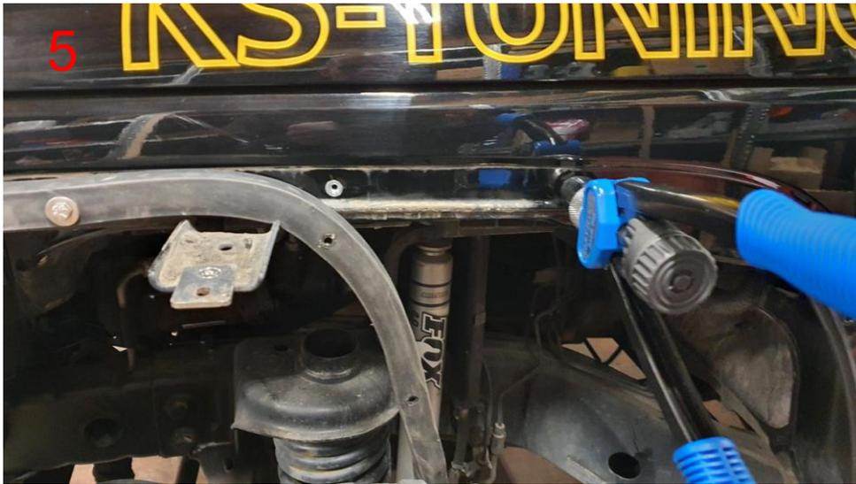
Montieren Sie nun in allen Löchern, in denen vorher die Original Plastikhalterungen waren, die mitgelieferten Einnietmuttern M6 mit geeignetem Werkzeug.
